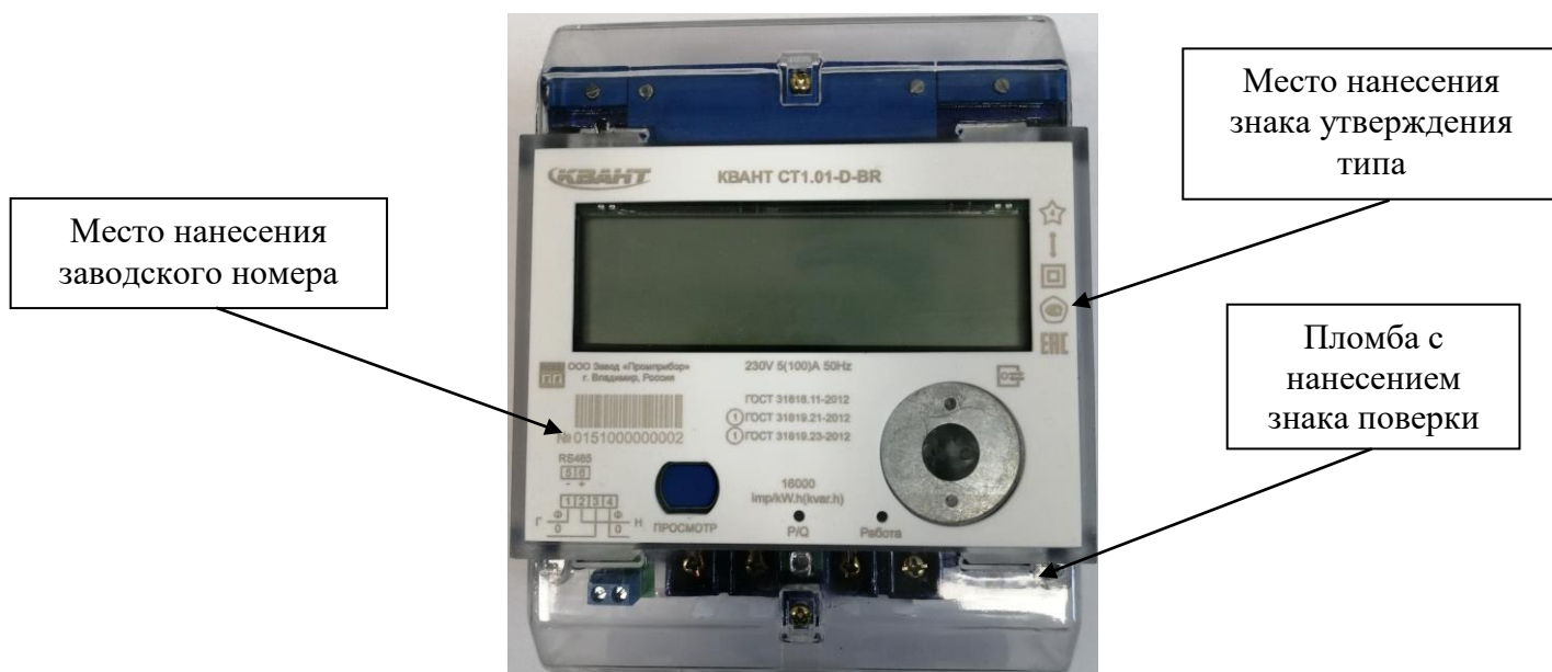
Рисунок 1 – Общий вид счетчика в корпусе типа D и W с указанием места ограничения доступа к местам настройки (регулировки), места нанесения знака утверждения типа, места нанесения заводского номера
