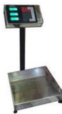
а) общий вид весов ВЕР-TORG-[М]-С-[Д] настольного исполнения с одним датчиком (1 – грузоприемная платформа; 2 – верхняя опорная рама; 3 – нижняя опорная рама; 4 – датчик; 5 – прибор весоизмерительный; 6 – регулируемая опора; 7 – пузырьковый уровень)
