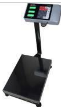
а) общий вид весов ВЕР-TORG-[М]-С-[Д] настольного исполнения с одним датчиком (1 – грузоприемная платформа; 2 – верхняя опорная рама; 3 – нижняя опорная рама; 4 – датчик; 5 – прибор весоизмерительный; 6 – регулируемая опора; 7 – пузырьковый уровень)
