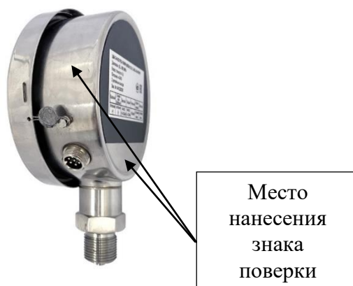
Рисунок 4 – Места нанесения на корпус манометров знака поверки
