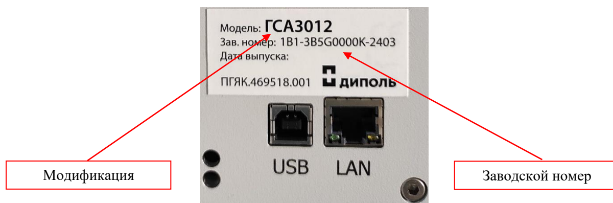
Рисунок 3 – Фрагмент задней панели генераторов с этикеткой
