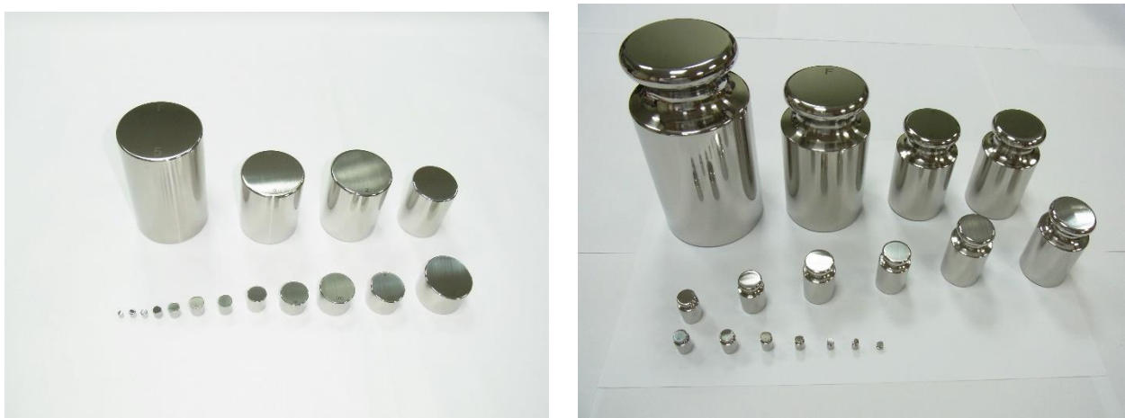
Рисунок 1 – Общий вид гирь 1 г – 10 кг цилиндрической формы без головки и с головкой
