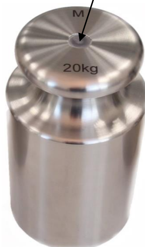
Рисунок 7 – Схема пломбировки от несанкционированного доступа и место нанесения знака поверки
