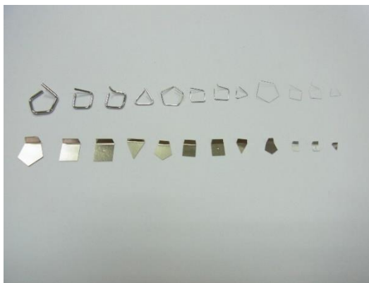
Рисунок 4 – Общий вид гирь миллиграммовых пластинчатых и проволочных
