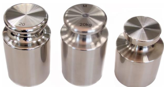
Рисунок 2 – Общий вид гирь 20 кг цилиндрических с головкой
