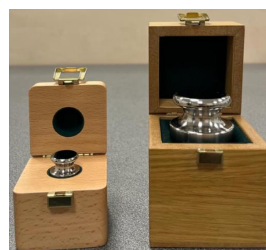
Рисунок 4 – Общий вид гирь миллиграммовых пластинчатых и проволочных
