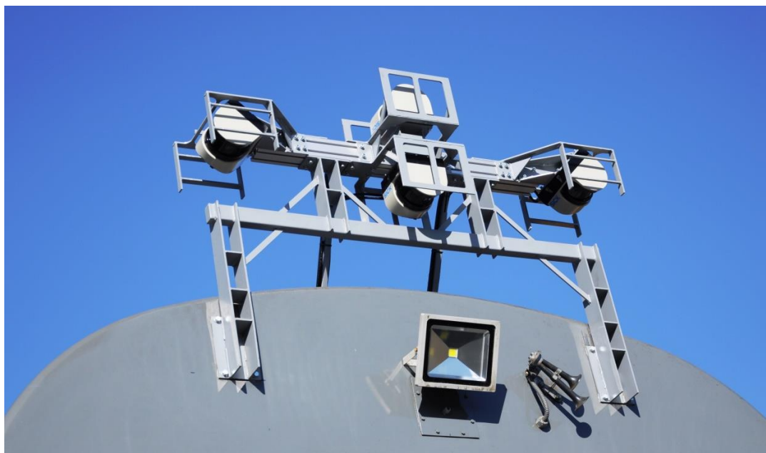
Рисунок 1 - Общий вид систем скоростного и высокоскоростного трехмерного сканирования «Габарит-М» установленных на вагоне (на фото рама с датчиками системы)
