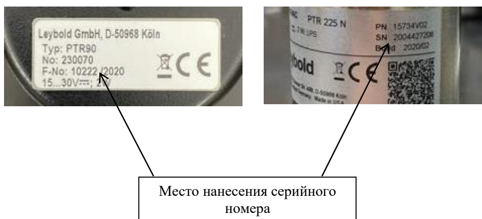
Рисунок 4 – Место нанесения серийного номера на датчик PTR90 и датчик PTR 225 N
