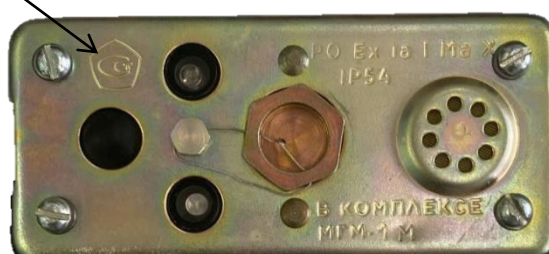
Рисунок 4 – Место нанесения заводского номера и знака утверждения типа
