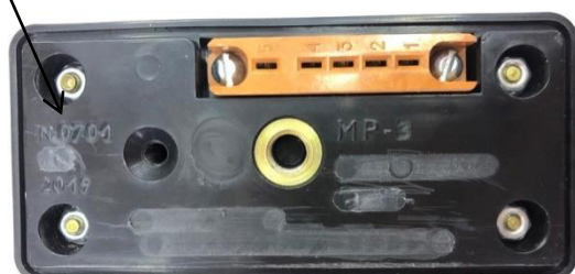
Рисунок 4 – Место нанесения заводского номера и знака утверждения типа
