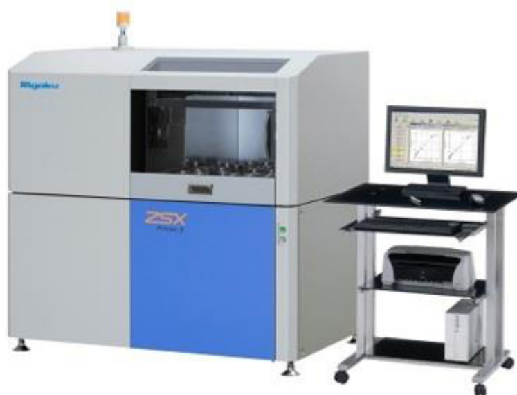
Рисунок 2 – Общий вид спектрометра ZSX Primus II с управляющим компьютером
