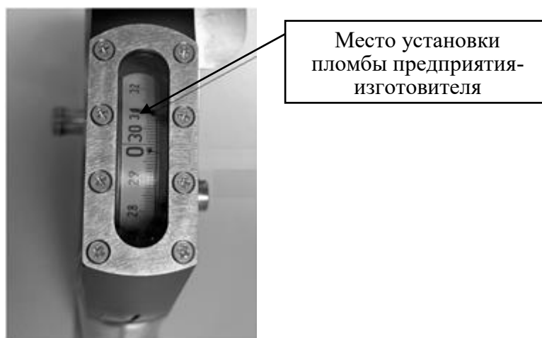
Рисунок 2 – Схема пломбировки уровнемеров
