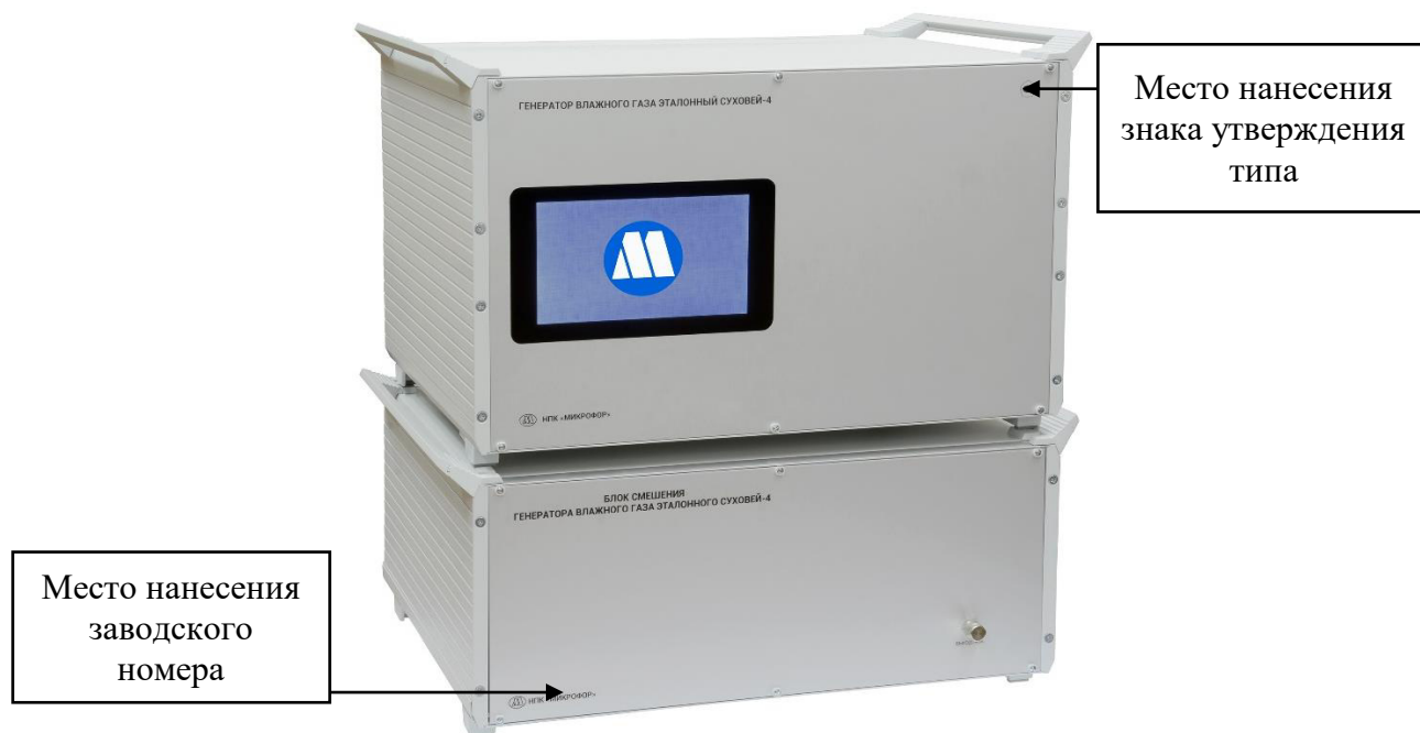
Рисунок 4 - Внешний вид генератора влажного газа эталонного Сухолей-4 в настольном исполнении с модулем управления и индикации с указанием мест нанесения знака утверждения типа и заводского номера.
