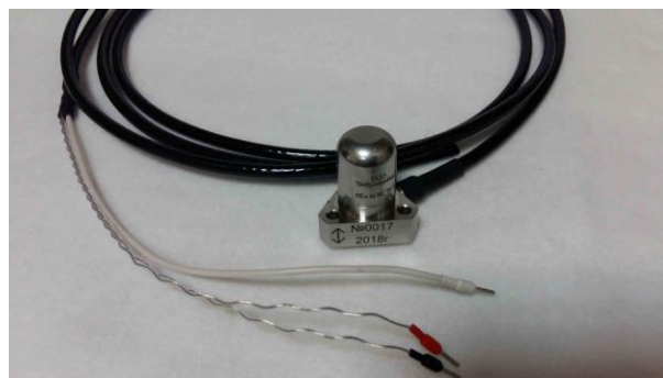
в) Датчики виброскорости с токовым выходом ДВСТ-4
