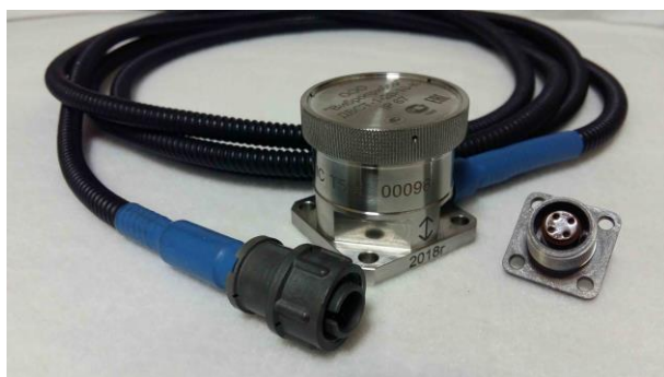
а) Датчики виброскорости с токовым выходом ДВСТ-1
