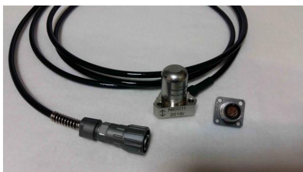
в) Датчики виброскорости с токовым выходом ДВСТ-4
