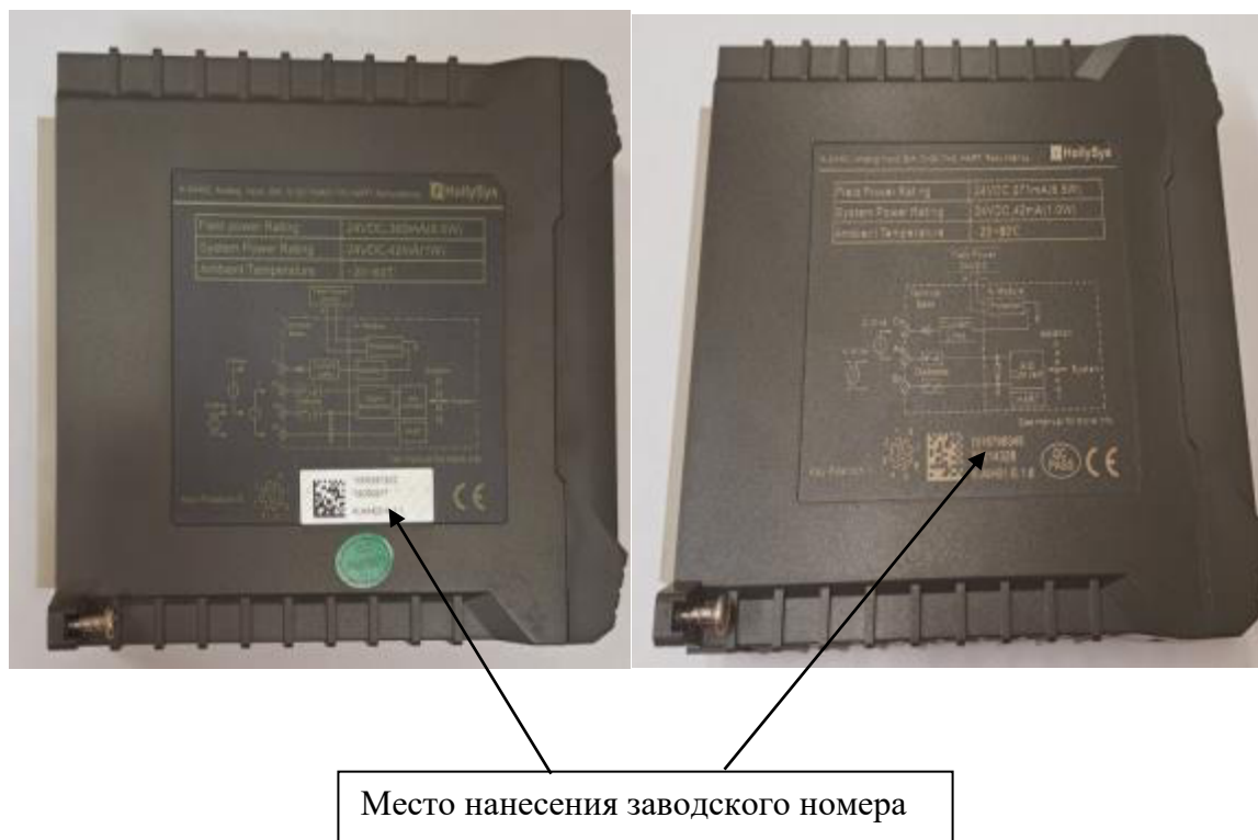
Рисунок 4 – Общий вид модулей CPU модификации MACS-K (DCS) с указанием места нанесения заводского номера
