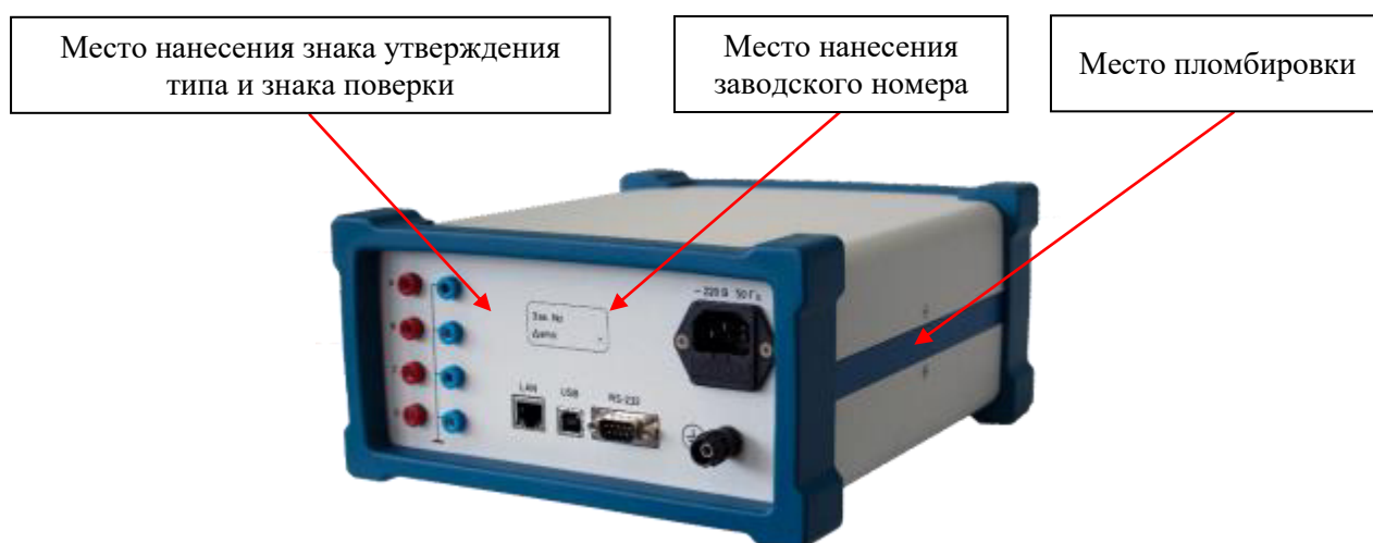
Рисунок 2 – Общий вид измерителя мощности термисторного унифицированного М3-121 с обозначением мест нанесения заводского номера, знака утверждения типа, знака поверки и пломбировки (вид сзади)
