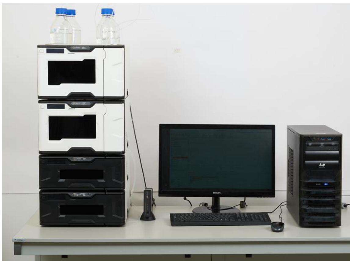
Рисунок 1 - Общий вид хроматографов LicArt 62
