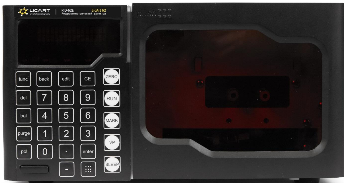
Рисунок 4 – Рефрактометрический детектор RID-62E (лицевая панель)
