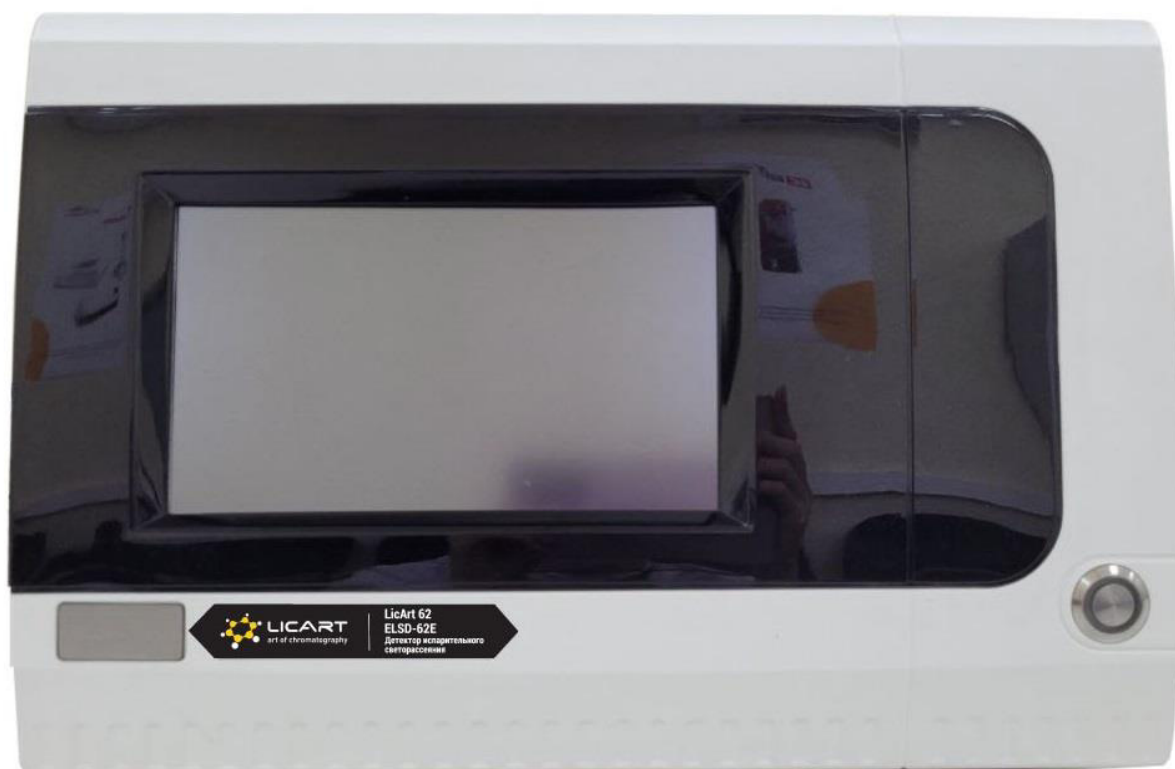
Рисунок 5 – Детектор испарительного светорассеяния ELSD-62E (лицевая панель)
