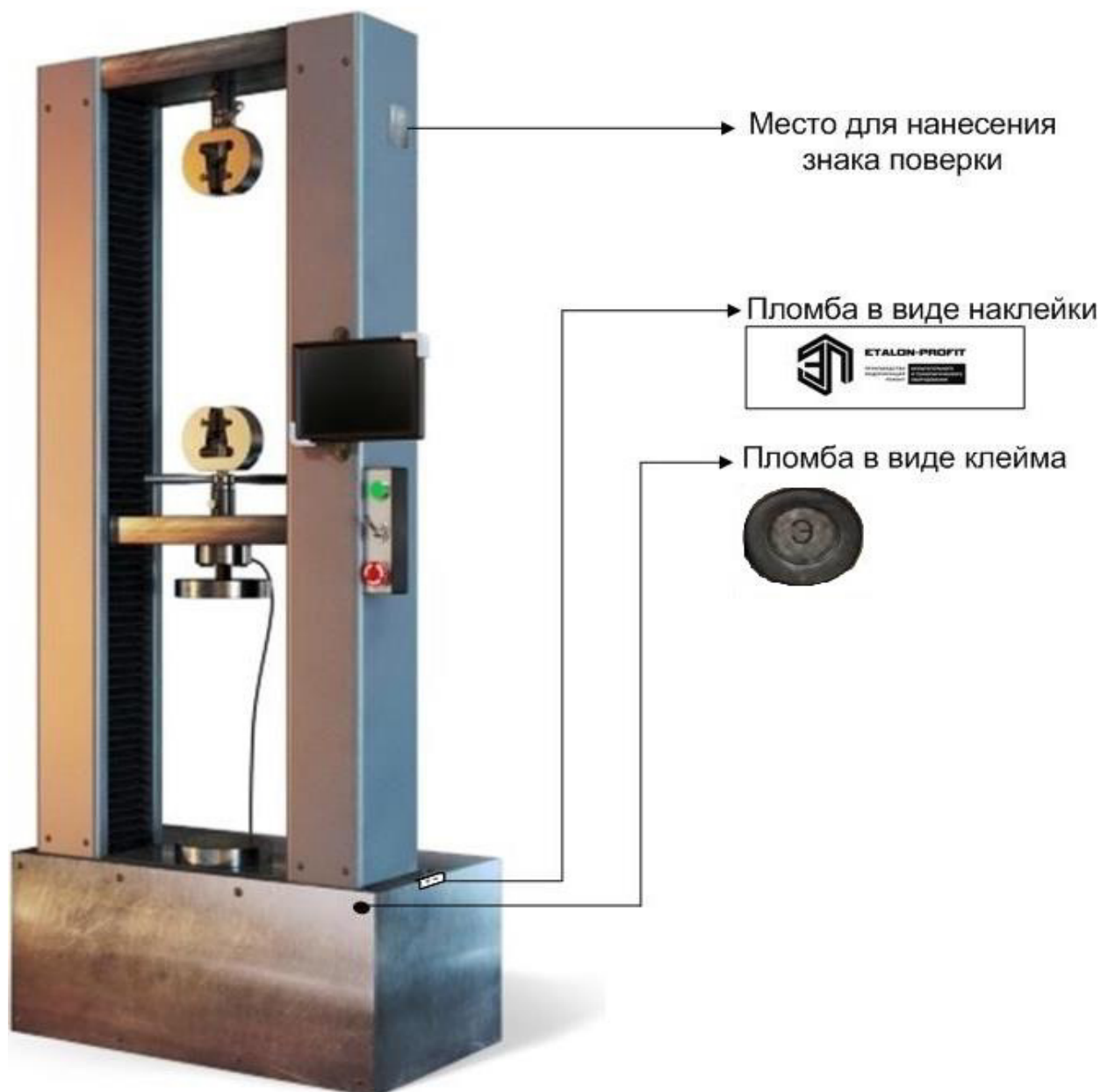
Рисунок 8 - Схема нанесения знака поверки и пломбирования машин серии РКМ исполнений РКМ 5.2, РКМ 10.2, РКМ 20.2, РКМ 50.2, РКМ 100.2 от несанкционированного доступа
