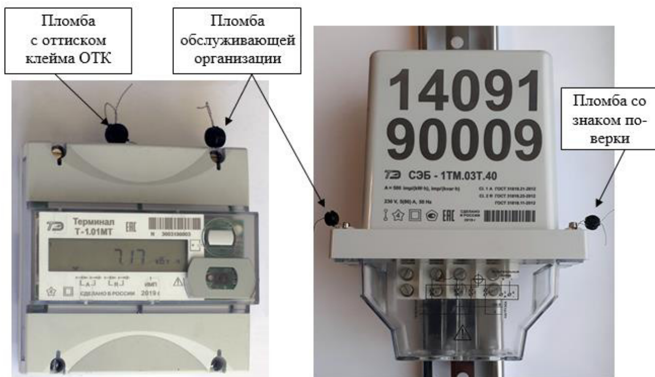
Рисунок 2 – Общий вид счетчика наружной установки, схема пломбировки от несанкционированного доступа, обозначение места нанесения знака поверки
