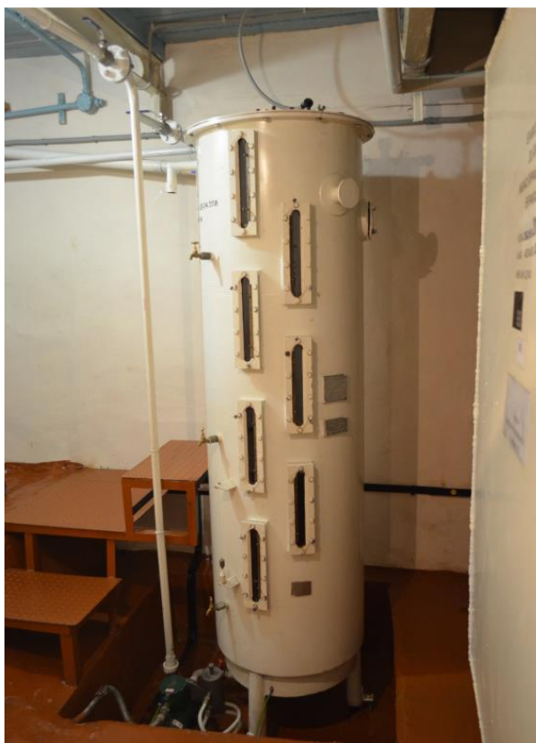
Рисунок 1 - Общий вид мерника МТВ-75Н, зав. № 085
