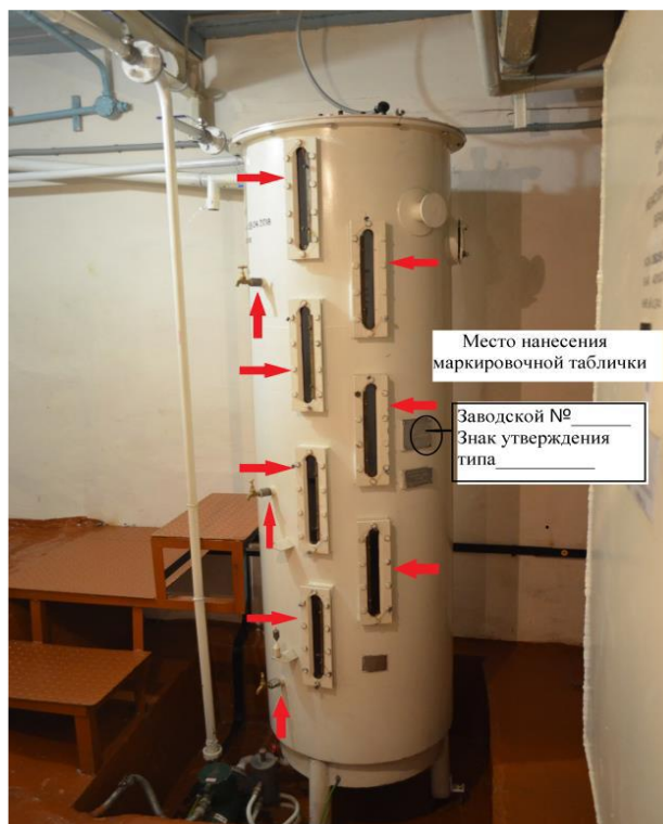
Рисунок 2 – Схема пломбировки мерника МТВ-75Н зав. № 085 от несанкционированного доступа, обозначение места нанесения знака поверки, заводского номера и знака утверждения типа
