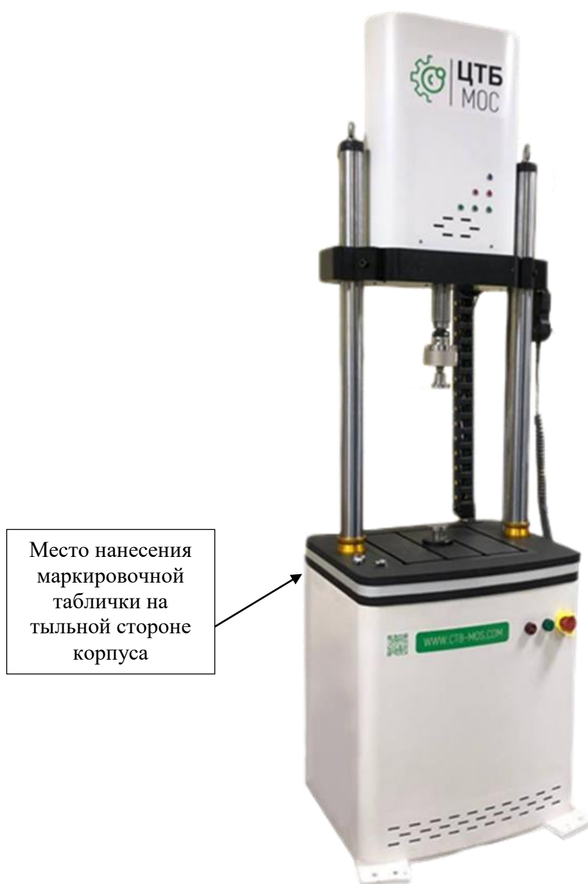
Рисунок 1 – Общий вид машин испытательных динамических МИД ЦТБ
