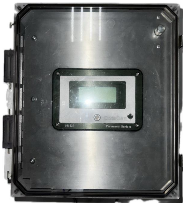
Рисунок 1 – Общий вид наземного блока для вывода измеренных значений термометра-манометра скважинного DataCan
