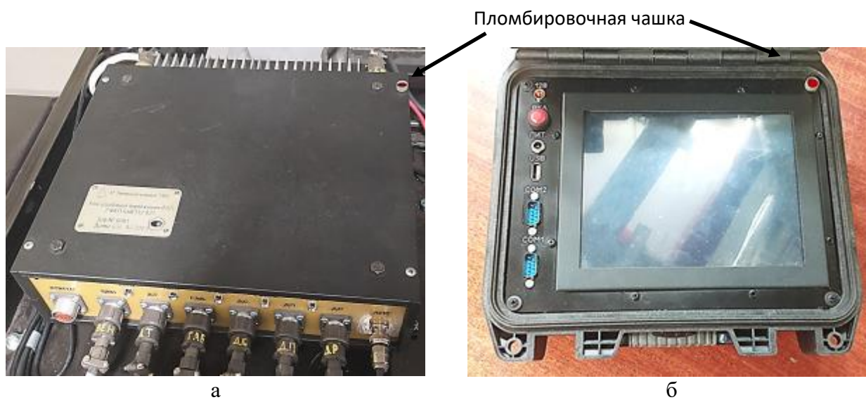
Рисунок 3 – Схема пломбирования от несанкционированного доступа. а- блок управления торможением (БУТ), б - блок управления и индикации (БУИ)
