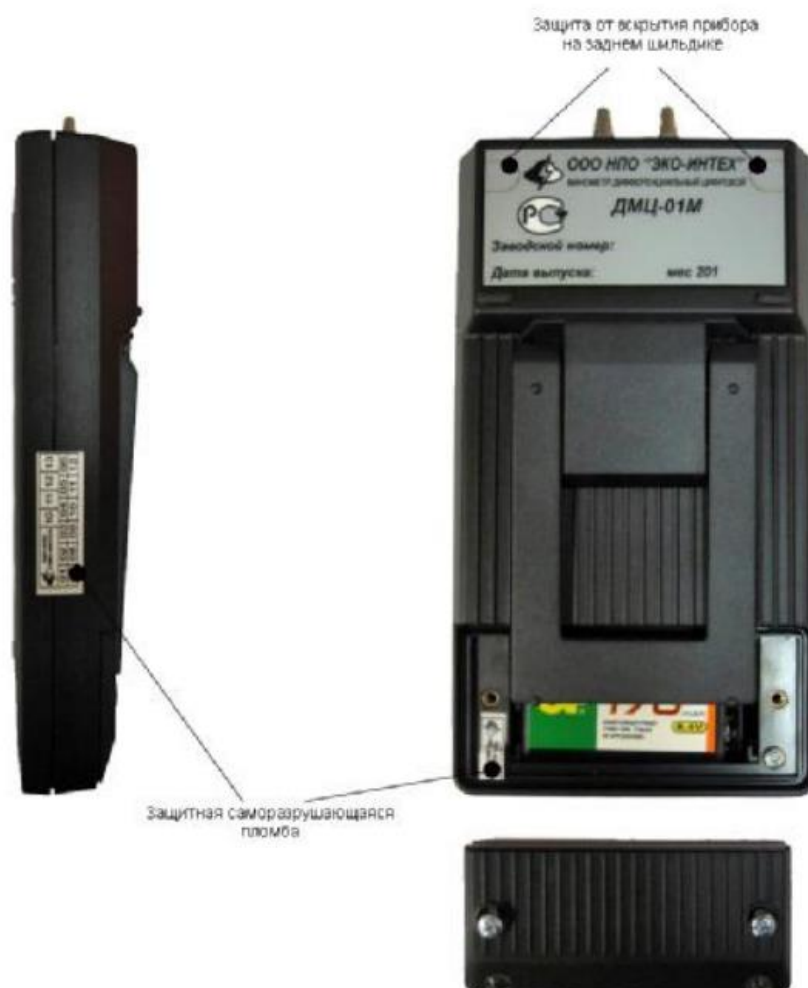
Рисунок 2 – Схема пломбирования дифманометра ДМЦ-01М
