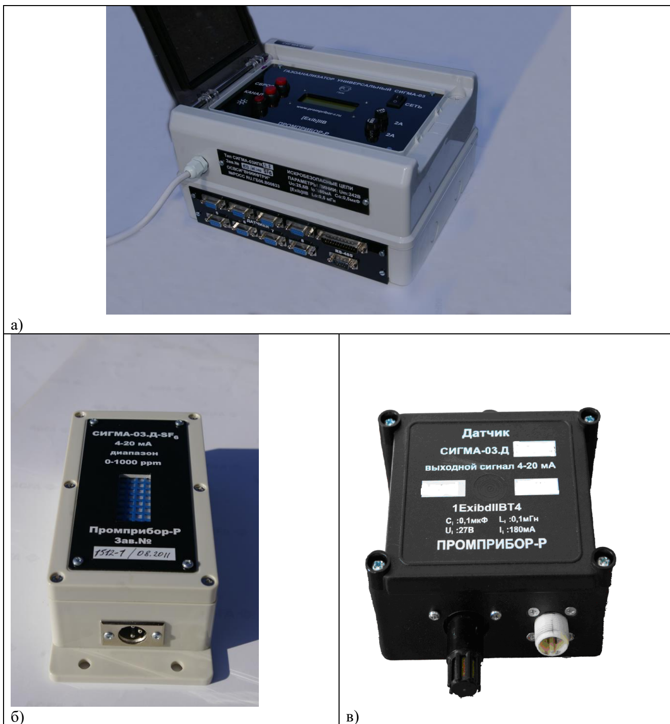
Рис.1 Общий вид блоков газоанализаторов Сигма-03 а) информационный блок СИГМА-03ИПК (модификация СИГМА-03ИПК8.8); б) датчик оптический СИГМА-03.Д- SF 6 , CO 2 , CO, хладонов R22, R123, R125, R134A, R404A; в) датчик СИГМА-03.ДВ, ДП, ДЭ.
