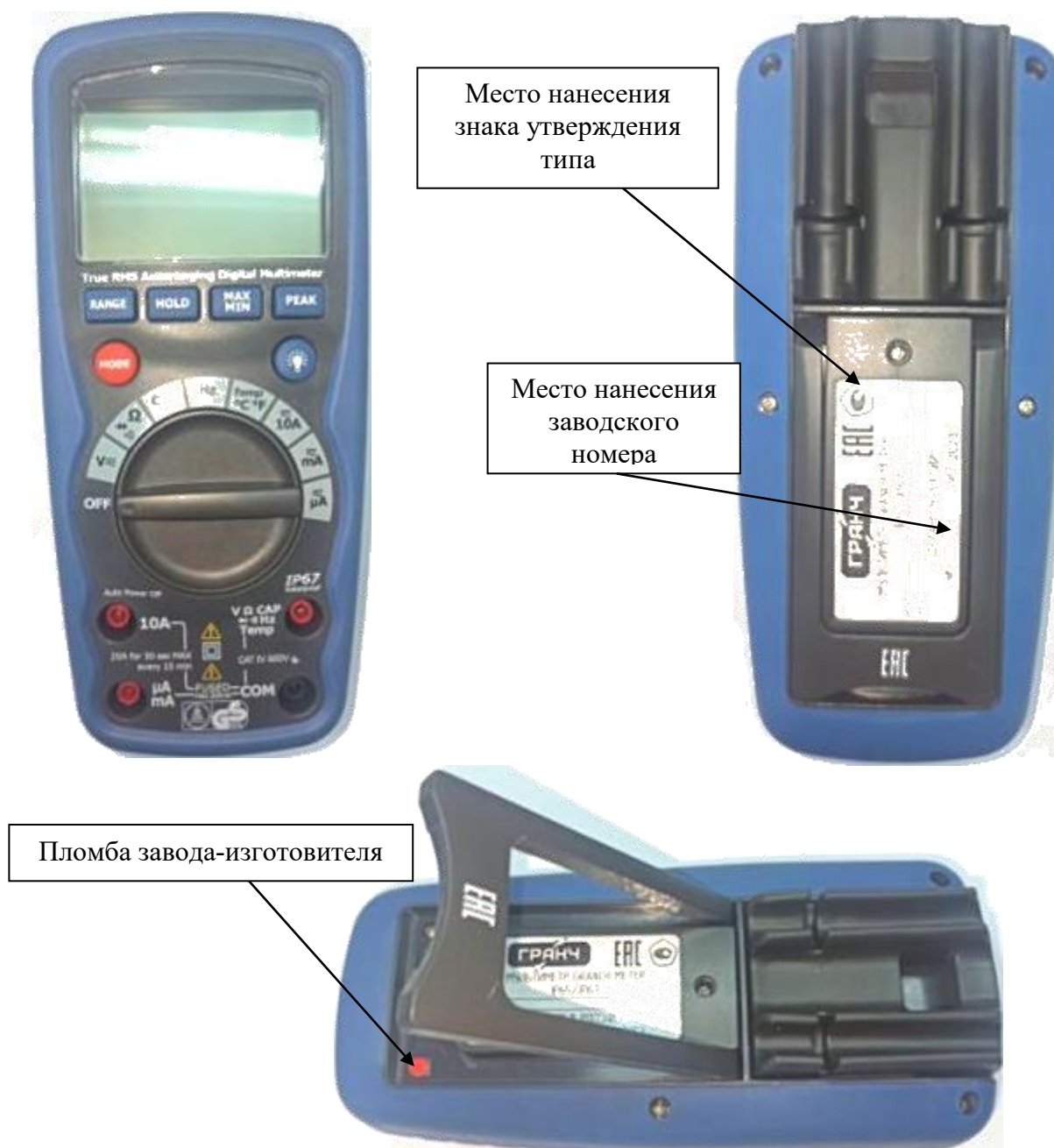
Рисунок 1 – Общий вид мультиметров модификации Granch Meter с указанием места пломбирования, места нанесения знака утверждения типа, места нанесения заводского номера
