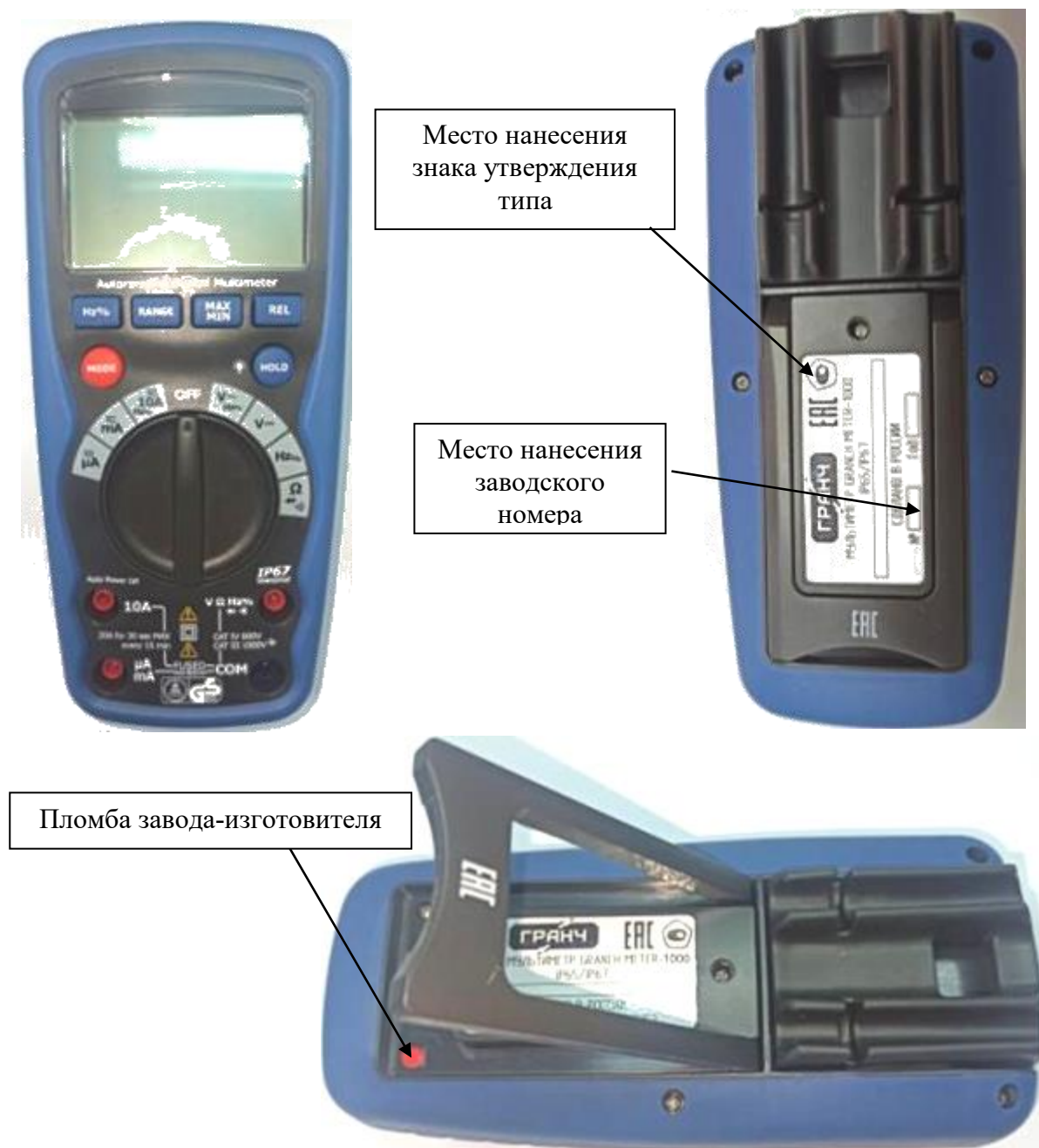
Рисунок 2 – Общий вид мультиметров модификации Granch Meter-1000 с указанием места пломбирования, места нанесения знака утверждения типа, места нанесения заводского номера
