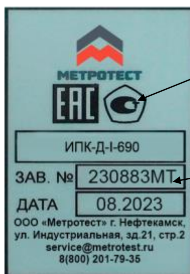
Рисунок 6 – Общий вид маркировочной таблички измерителей перемещений (деформаций) контактных длинноходовых ИПК-Д
