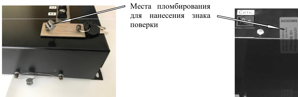
Рисунок 5 – Схемы пломбировки отсчетного устройства Север-4К и ЭКО и нанесения знака поверки
