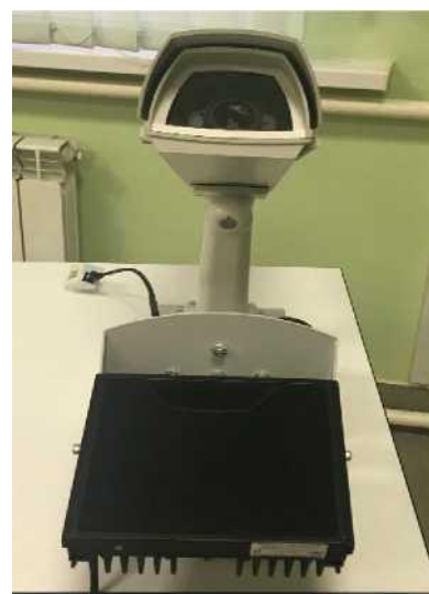
Рисунок 3 – Внешний вид сервера SecurOS-IVS-NVR-AUTO-PRO-6 комплекса в варианте исполнения «ЦОД» с местами пломбирования сервера
