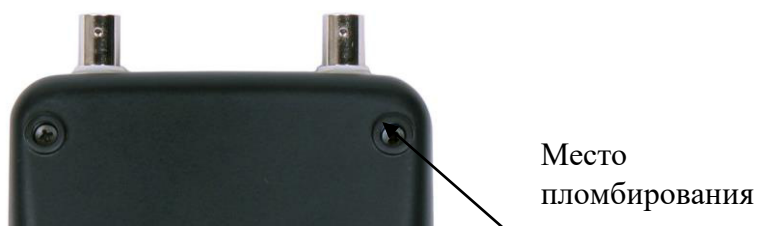
Рисунок 3 - Место нанесения пломбировки от несанкционированного доступа на панели прибора
