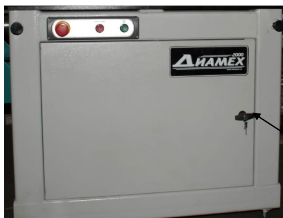
Рисунок 2 - Вид спереди шкафа управления и схема пломбировки от несанкционированного доступа
