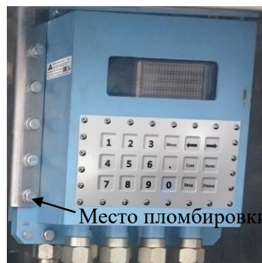
Рисунок 6 – Место пломбировки контроллера «Алкоспот ТР»
