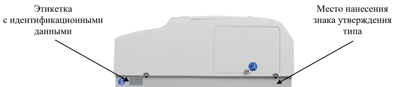
Рисунок 3 - Задняя панель спектрофотометра SPECORD 250 PLUS с указанием мест нанесения идентификационных данных, включая дату изготовления, и знака утверждения типа
