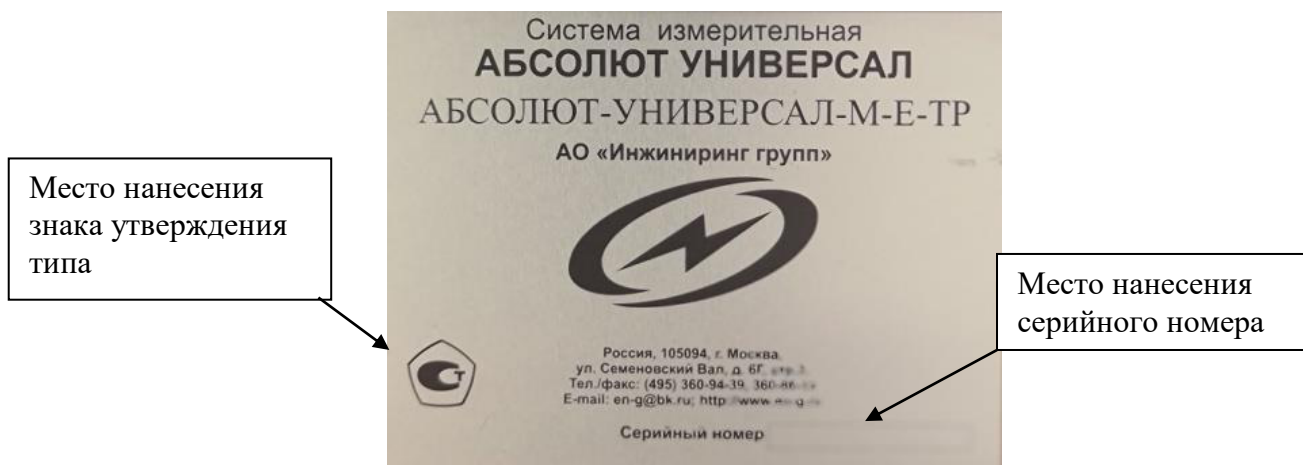
Рисунок 9 - Место нанесения серийного номера и знака утверждения типа.
