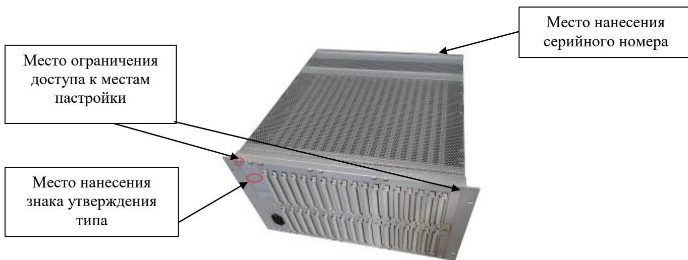
Рисунок 2 - Общий вид систем исполнения УЛЕЙ модуль Б с указанием места ограничения доступа к местам настройки, места нанесения знака утверждения типа, места нанесения серийного номера
