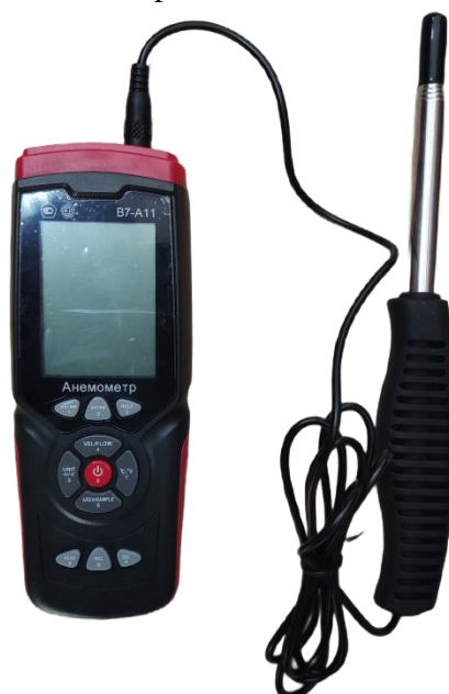
Рисунок 6 – Анемометр модификации B7-A11
