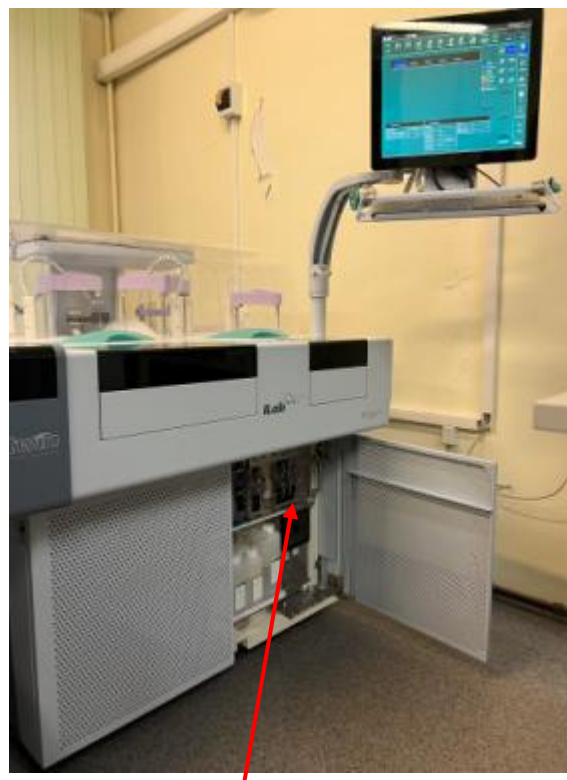
Шприцы ионно-селективного модуля Анализатор ILab Taurus с ионно-селективным модулем
