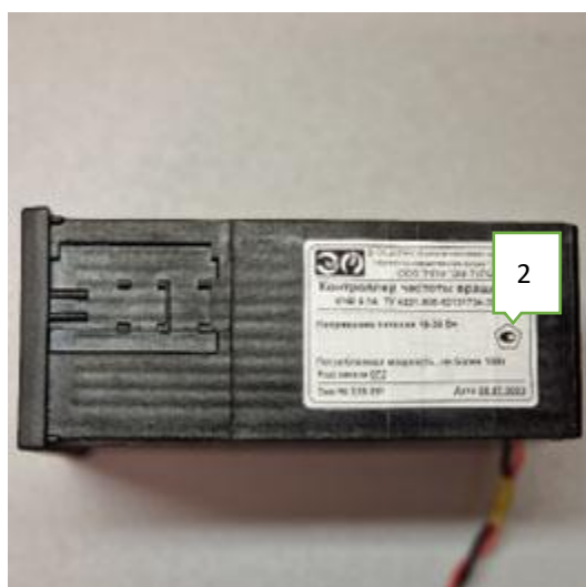
Рисунок 2 – Места пломбирования и нанесения заводского номера и знака утверждения типа контроллеров (1 - Место пломбирования; 2 - Место нанесения знака утверждения типа) а) – исполнение КЧВ5.1АМ, б) исполнение КЧВ5.1SRT, в) исполнение КЧВ5.1А
