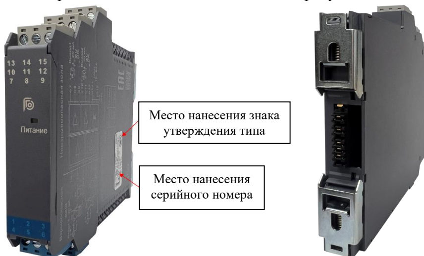
Рисунок 1 – Общий вид барьеров с указанием места нанесения серийного номера и места нанесения знака утверждения типа
