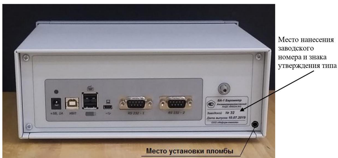
Рисунок 2 — Схема пломбирования барометров БА-1
