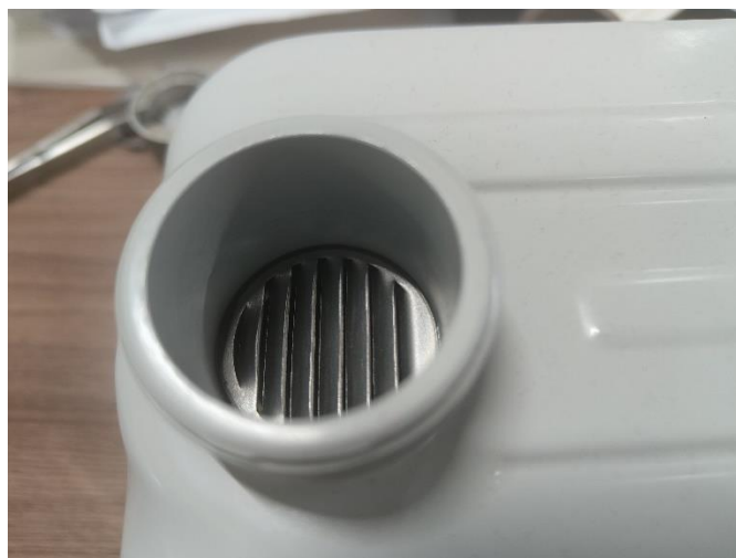
Рисунок 3 – Общий вид патрубка счетчика с дополнительной вставкой
