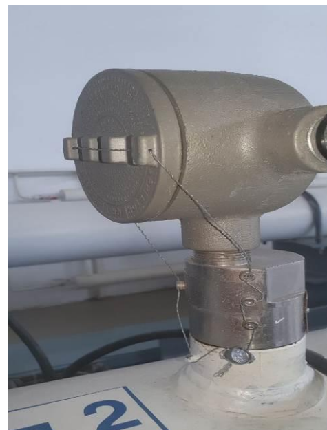
а) пломбирование детектора
