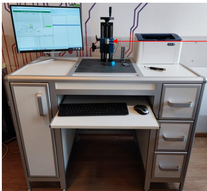
Рисунок 1 – Общий вид компараторов ПКМ-100-01, ПКМ-100-02, ПКМ-100-03 и ПКМ-100-04, а также места нанесения заводского номера и знака утверждения типа
