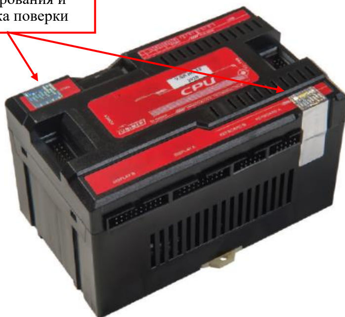
Рисунок 11 – Места пломбирования и нанесения знака поверки блока ЦПУ
