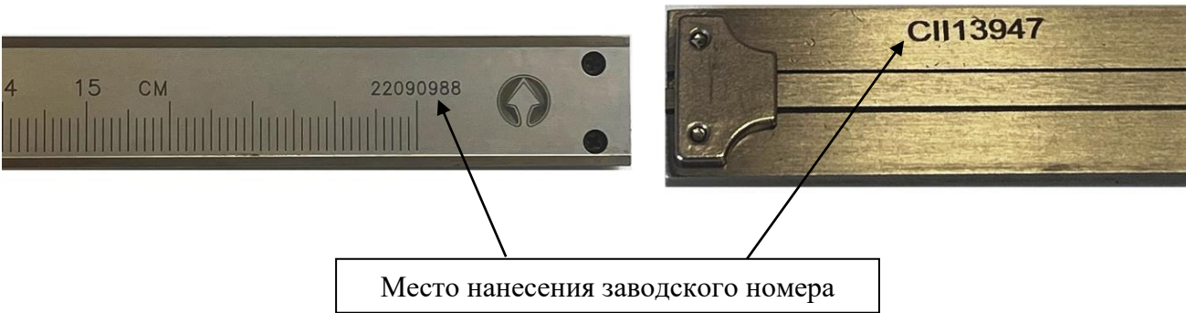
Рисунок 15 – Места нанесения заводских номеров
