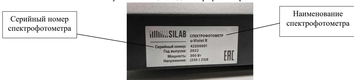
Рисунок 2 – Вид информационной таблички с серийным номером для спектрофотометров u-Violet
