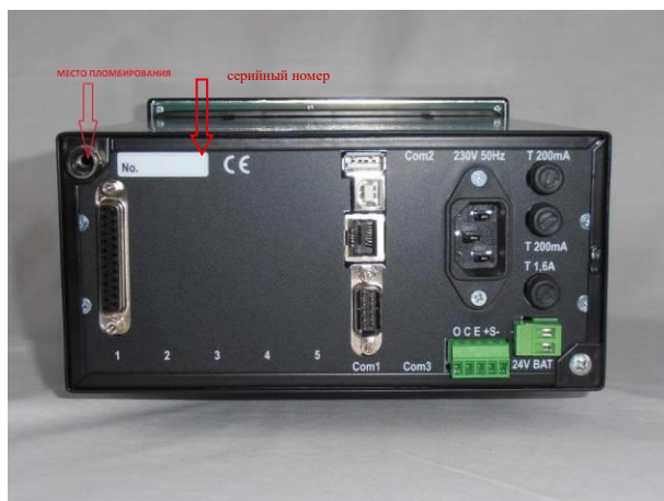
а – задняя панель вычислителя – пломбирование винта крепления задней панели, место нанесения серийного номера
