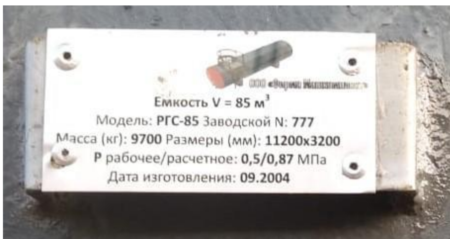
Рисунок 3 – Табличка с заводским номером резервуара горизонтального стального цилиндрического РГС-85
