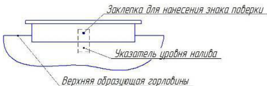
Рисунок 2 – Схема пломбировки от несанкционированного изменения положения указателя уровня налива, обозначение места нанесения знака поверки.
