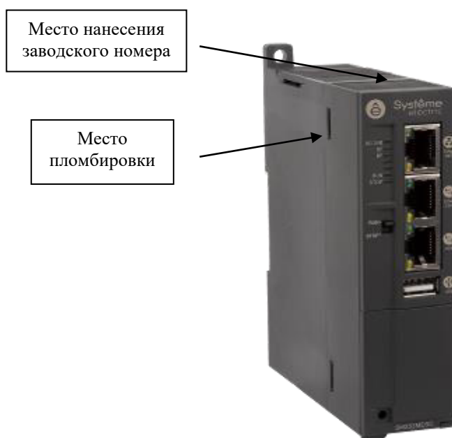
Рисунок 1 - Общий вид контроллера программируемого логического SystemePLC S250 (модификация SM253CE10 с модулями расширения), место нанесение заводского номера и место пломбировки
