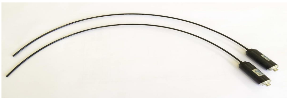
Рисунок 3- Общий вид сцинтилляционного блока детектирования ионизирующего излучения дозиметров многоканальных клинических МКД-04
