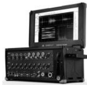
Рисунок 1 – Общий вид модульной системы сбора данных SIRIUS-R2DB-SYSTEM с двумя модулями измерительными SIRIUSir-8xMIC200
