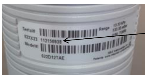
Рисунок 3 – Место нанесения идентификационного номера на датчик мембранно-емкостной Baratron 622D
