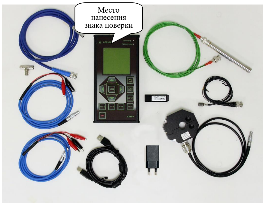
Рисунок 1 – Общий вид концентратора-анализатора низкочастотных сигналов многофункционального СКМ-8 с обозначением места нанесения знака поверки
