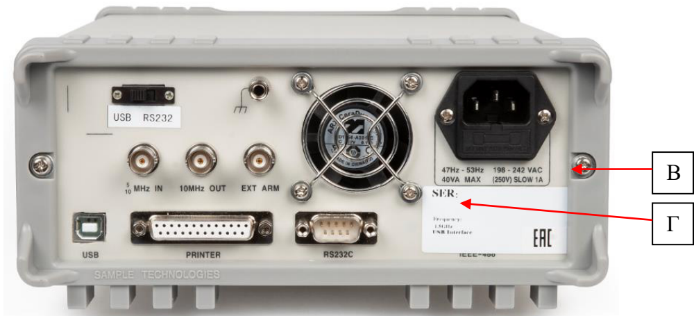
Рисунок 4 – Схема пломбирования от несанкционированного доступа (В) и место нанесения серийного номера (Г)
