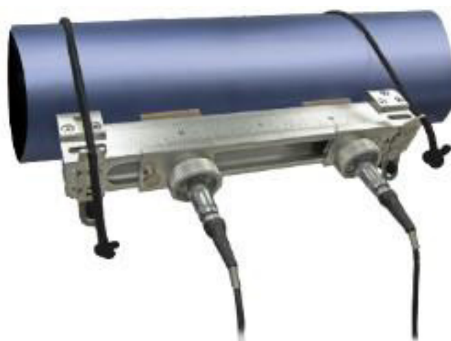
Рисунок 19. Накладной УЗП SE 1790 Пример установки на трубопроводе
