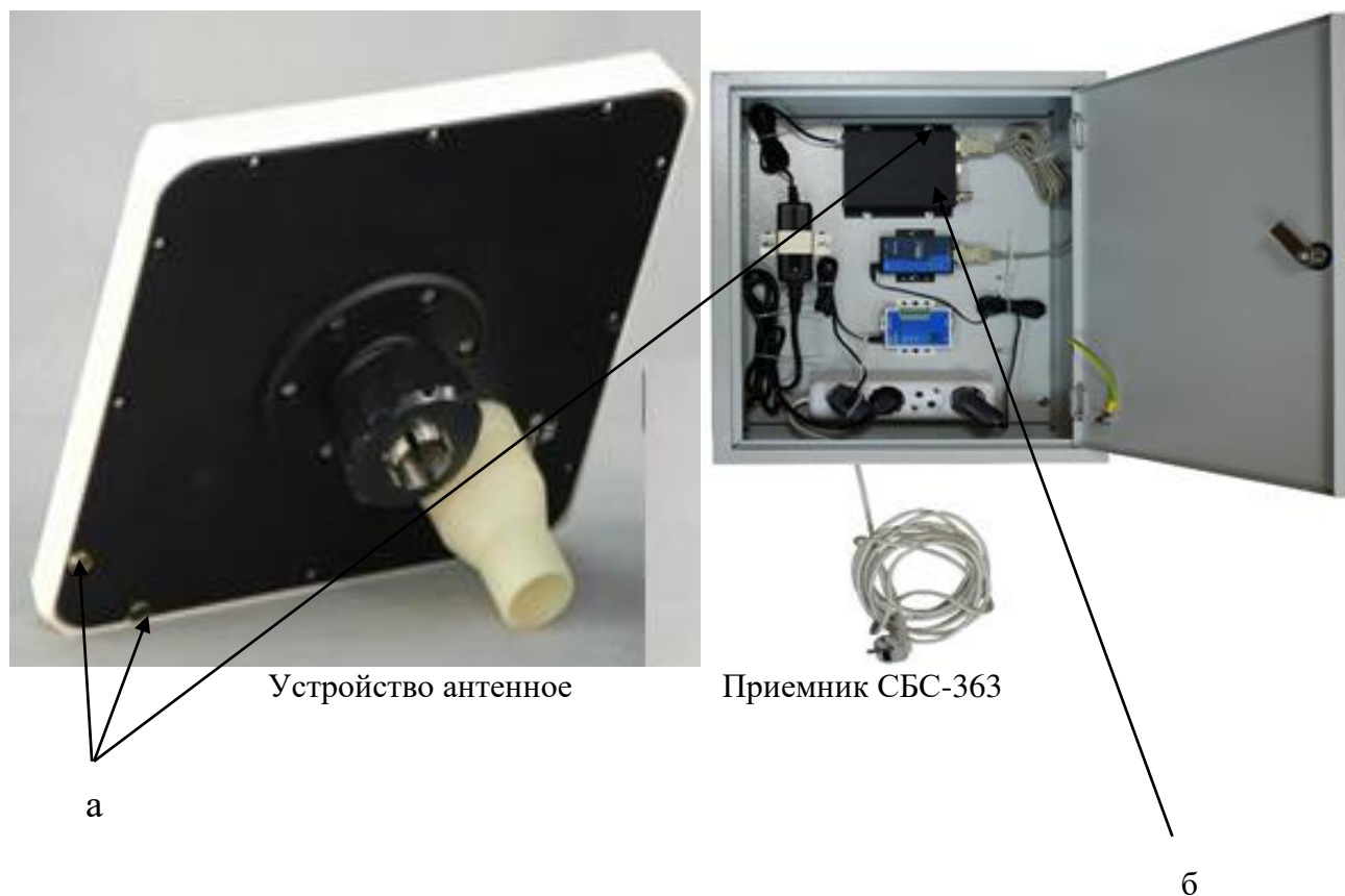
а – место пломбировки от несанкционированного доступа б – место нанесения наклейки со знаком утверждения типа Рисунок 1 – Внешний вид СБС
