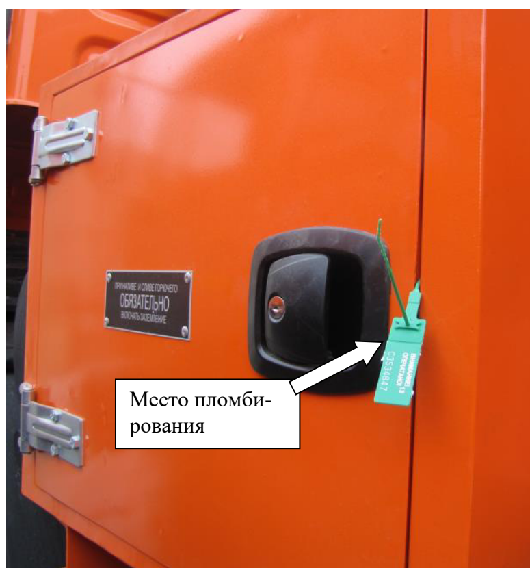
Рисунок 6 – Отсек для размещения узла выдачи топлива
