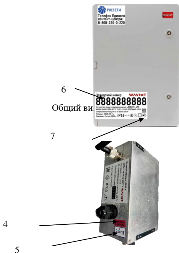
Базовая станция NB-Fi У
