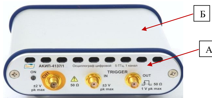
Рисунок 1 – Общий вид осциллографов, место нанесения знака утверждения типа (А) и знака поверки (Б)
