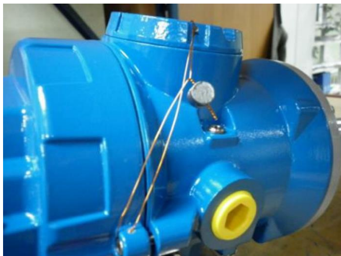
Рисунок 2 - Места нанесения поверительных клейм (наклеек и пломб)
