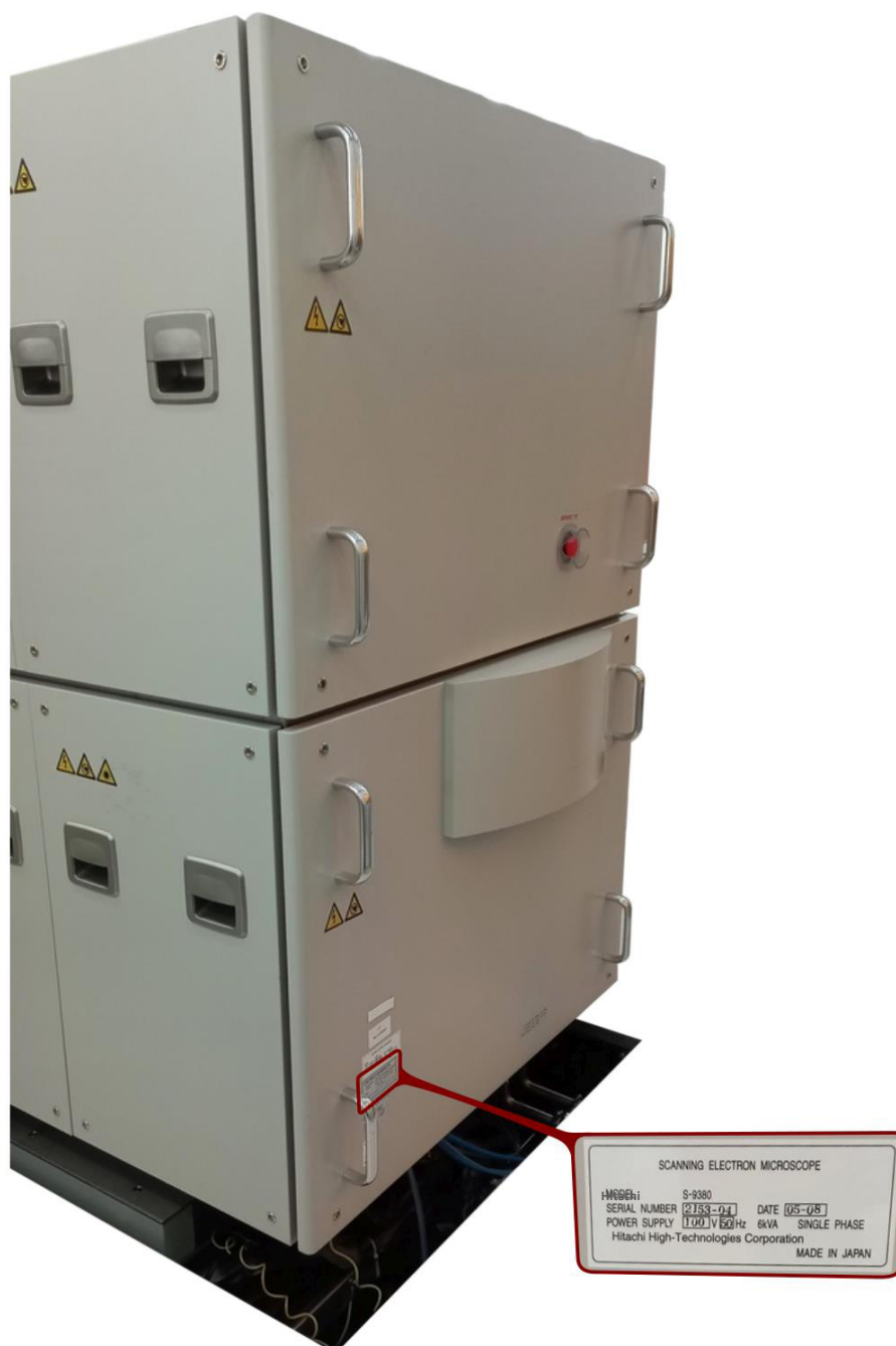
Рисунок 2 – Общий вид и схема маркировки микроскопа растрового электронного Hitachi S-9380
