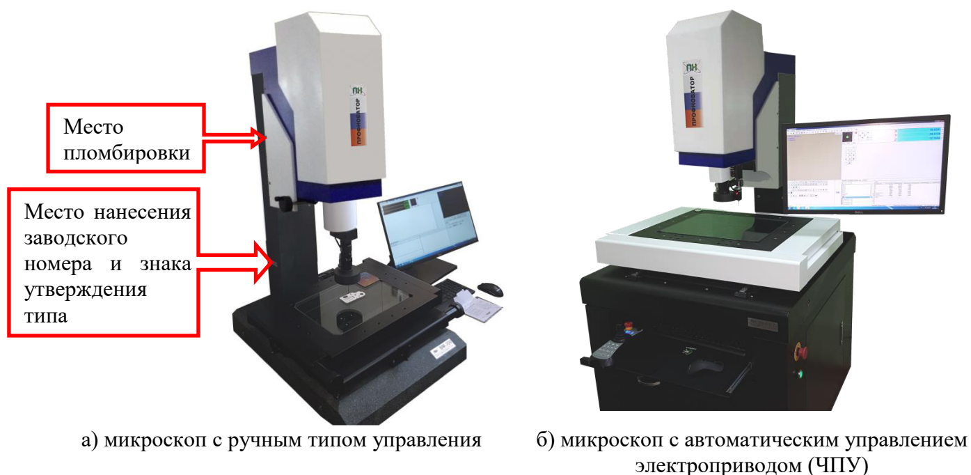
Рисунок 1 – Общий вид и схема пломбировки микроскопов видеоизмерительных серий MB и MBZ
