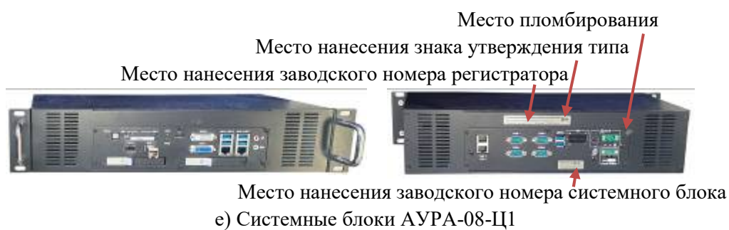
Рисунок 2 – Общий вид системных блоков с указанием мест пломбирования, мест нанесения знака утверждения типа и заводского номера
