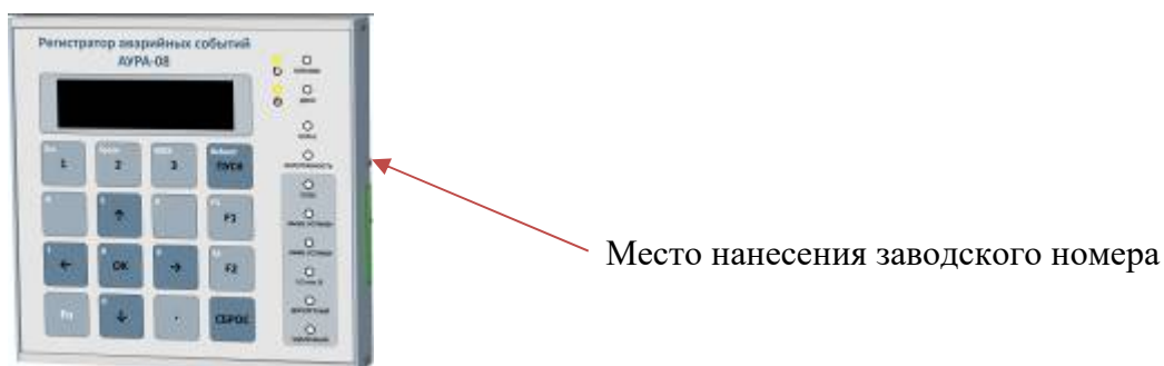
Рисунок 3 – Общий вид пульта индикации и управления с указанием мест нанесения заводского номера
