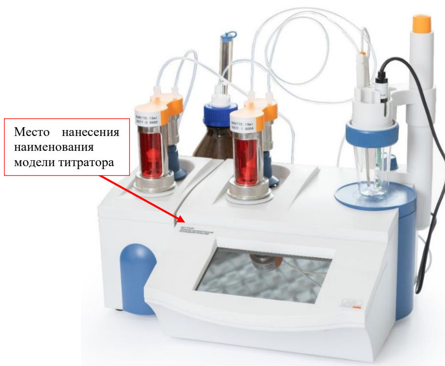
Рисунок 1 – Общий вид титратора автоматического NLT модели NLT-P50p с подключенным дополнительным приводом бюретки
