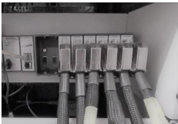
Рисунок 3 – Шасси NI cRIO-9145 с измерительными модулями NI 9205
